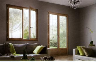
Oxxobaies fait évoluer sa gamme de fenêtres et portes-fenêtres Oxalis (Uw inférieur ou égal à 1,4 W/m2.K avec un double vitrage standard, 0,9 W/m2.K avec un triple vitrage). Elles sont, désormais, associées aux volets roulants PVC Solstice (coffre extérieur) et Eclipse (coffre intérieur).
