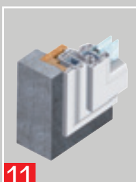
Dormant spécial rénovation avec aile compensée de 32 mm
