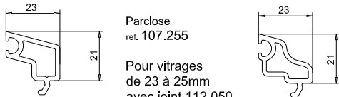
Parclose moulurée ref. 107.211 Pour vitrages de 23 à 25mm avec joint 112.05
